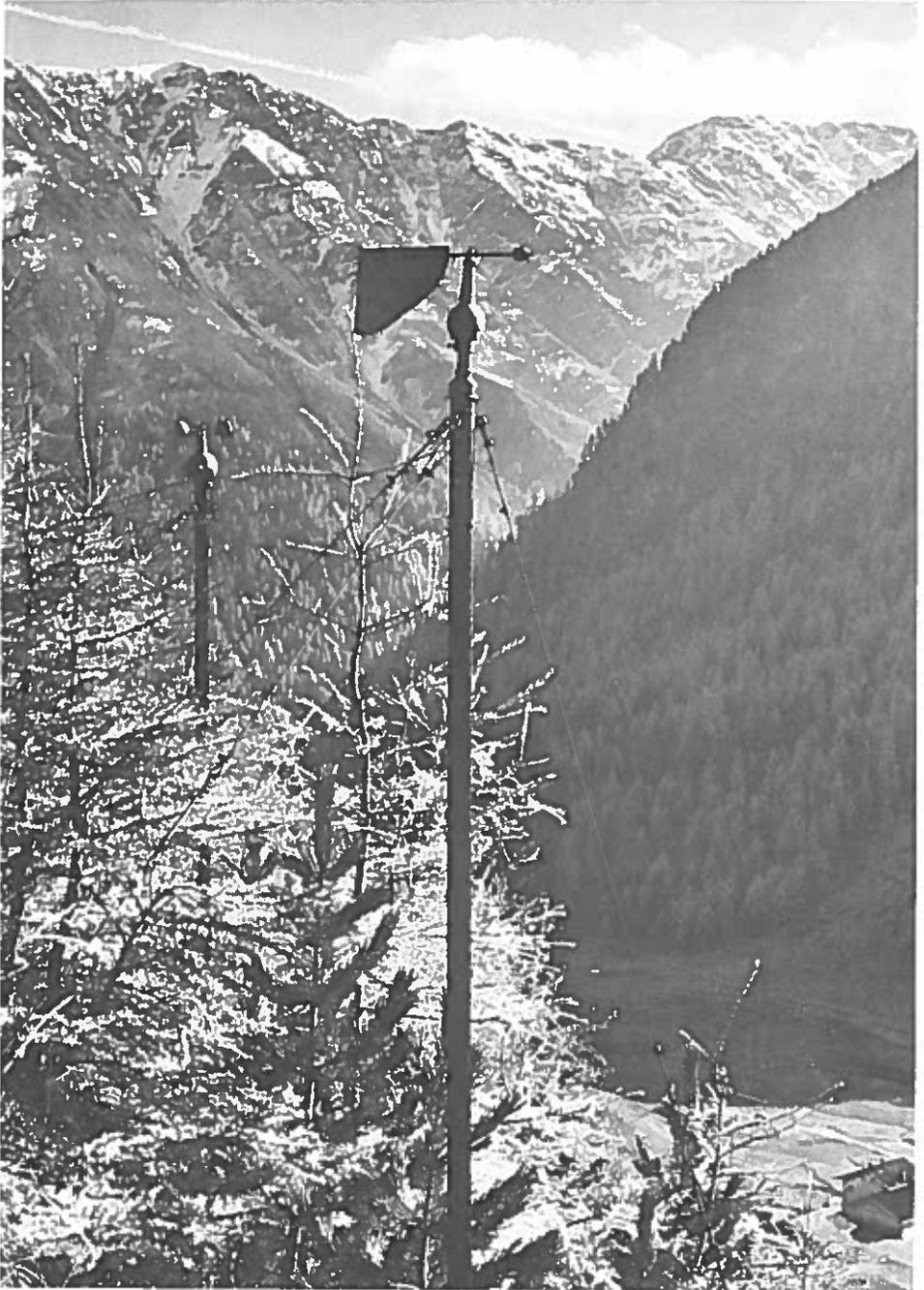
Abbildung 5: Windfahne und Schalenkreuzanemometer an der Bezugsstation 3 m über dem Boden 1790 m ü. A.
